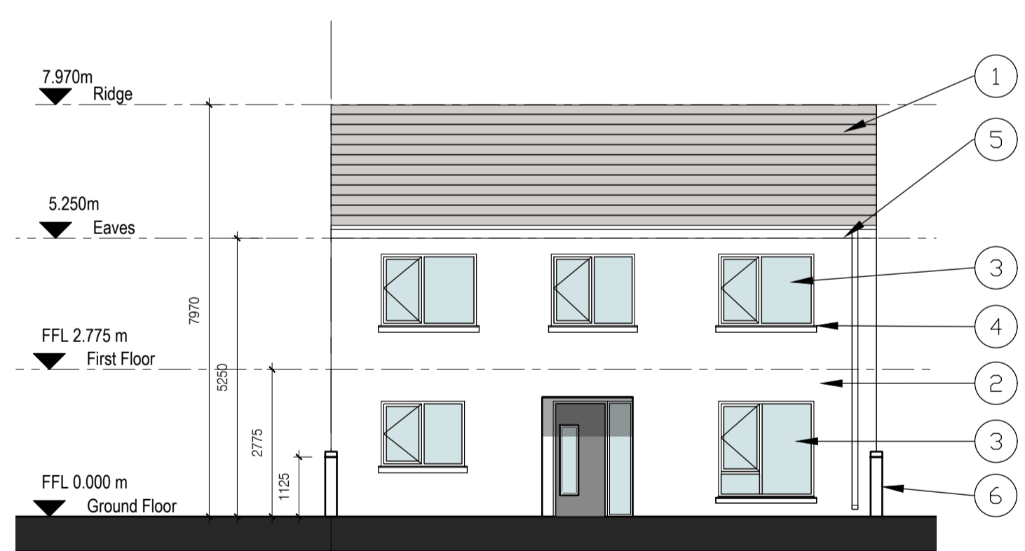
4 Front Elevation A Scale: 1:100
